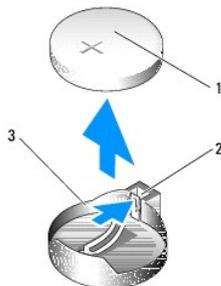
**⚡ AVIS :** Si vous sortez la pile de son support avec un objet pointu, prenez garde de ne pas toucher la carte système avec l'objet. Vérifiez que l'objet est inséré entre la pile et son support avant de tenter d'extraire la pile. Autrement, vous pourriez endommager la carte système en délogant le logement de la pile ou en rompant les circuits imprimés sur la carte système.
